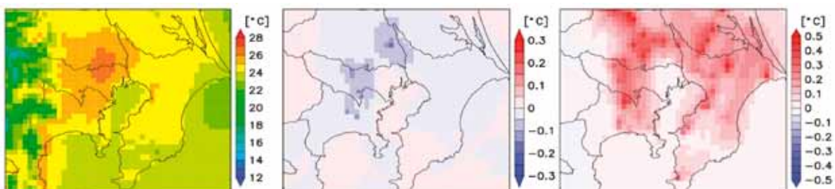
図7：都市気候の将来予測の結果。左図は2050年代のある年の8月の地上高さ20mの気温分布。中央図と右図はそれぞれ、都市が集約型になること、分散型になることよって起こる気温上昇量(気象研究所モデルの結果)。
